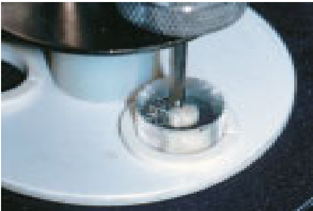
FIGURA 1: Aplainamento da superfície de colagem na politriz, com utilização de lixas 400 e 600.
