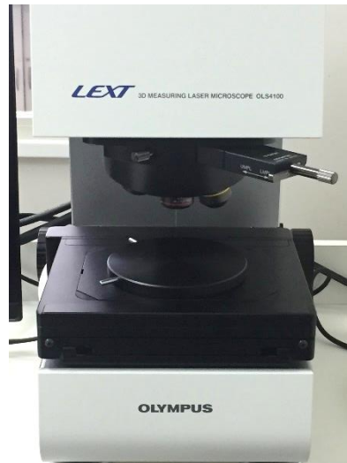
Figura 4. Microscópio a laser de varredura confocal. (Olympus OLS 4100, 3D measuring laser microscope , Tóquio, Japão)
