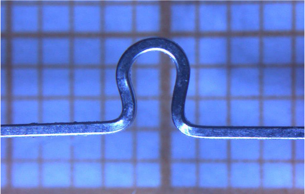
Figura 11) Imagem do segmento com ômega do Esthetic Rhodium após exposição ao meio bucal mostrando perda de revestimento estético nas áreas escuras (sem brilho).
