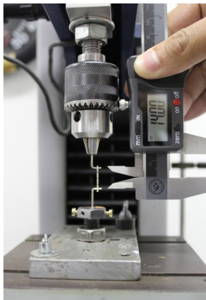
Figura 4 - Máquina de ensaios de tração com distância fixa entre os ganchos de 14 mm
