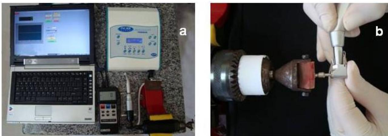
Figura 4 a- Ilustração do equipamento para o ensaio de inserção e remoção dos mini-implantes: torquímetro digital, micromotor com redutor de velocidade, motor cirúrgico, torno de bancada e computador(a); inserção do mini-implante com a chave curta em contra-ângulo com redução de velocidade no bloco de costela suína acoplado à peça metálica do torquímetro (b).
