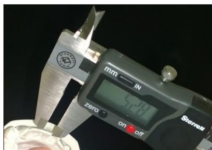
Figuras 1 e 2 - Paquímetro digital posicionado, referente ao maior diâmetro mesiodistal.
