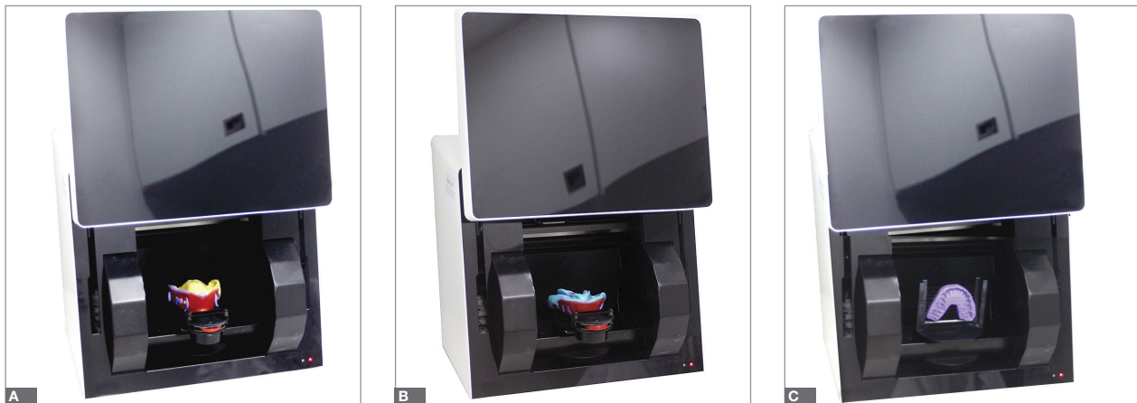
Figura 2: Sequência de escaneamento de moldagens em silicone de adição: A) escaneamento do molde superior, B) escaneamento do molde inferior, C) escaneamento do registro de mordida.
