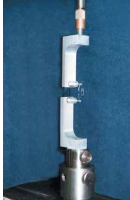
Figura 3 – Alça sendo ativada no ensaio de tração.
