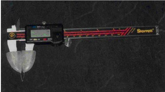
Figura 1 - Fotografia do paquímetro digital com a ponteira de acrílico adaptada para facilitar as medições.
